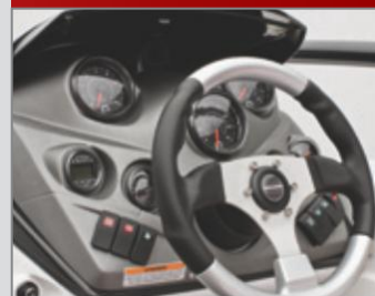
Полфункциональная приборная панель с глубиномером
